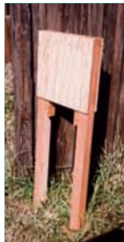
Une grande « pince à linge », utilisée pour tenir le coffrage en place.
